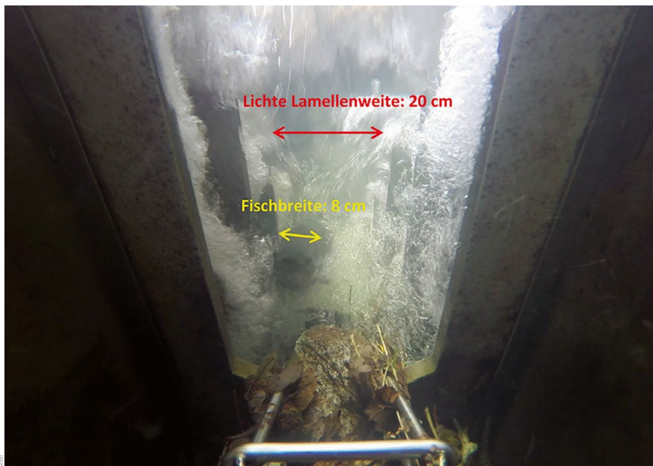
Bild 8: Fischversuch mit einer Regenbogenforelle als Basis zur Systemauslegung für Großsalmoniden (Huchen, Seeforelle) - Ausschnitt aus der Videoanalyse
